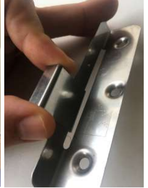
Hareketli klips (orjinal paslanmaz) Genleşmeye izin veren 2 parçadan oluşur.
